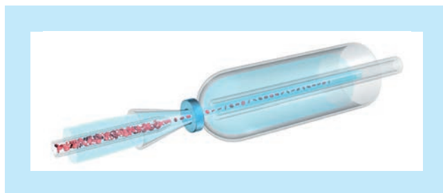
Ryc. 4 Przepływ cząsteczek w metodzie ogniskowania hydrodynamicznego
